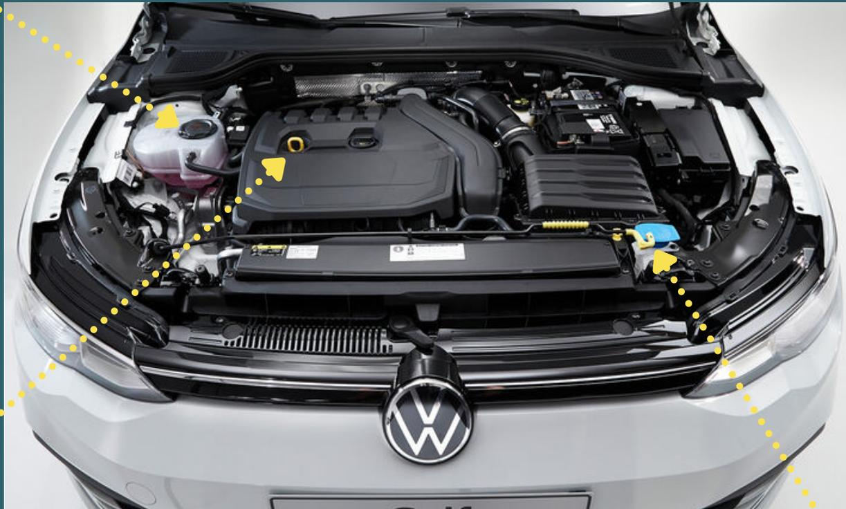
**Motorenöl:** Messstab bei ausgeschaltetem Motor heraus ziehen, reinigen und erneut einführen. Minimum- Maximum Markierung beachten. Bei Bedarf mit Motorenöl nachfüllen.
