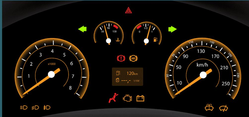
Dein Fahrzeug ist mit einem Armaturenbrett ausgestattet, welches dir die wichtigsten Informationen zum Fahrzeug liefert. Informationen zu; Geschwindigkeit, Drehzahl des Motors, Bremsen, Wassertemperatur, Treibstoffmenge, eingeschaltete Lichter oder Richtungsanzeiger, nicht verschlossenen Türen und vielem mehr. Der Betriebsanleitung deines Fahrzeugs kannst du ausserdem weitere Informationen entnehmen, wie du beispielsweise Handeln musst, wenn eine Fehlermeldung erscheint. Grundsätzlich gilt;
