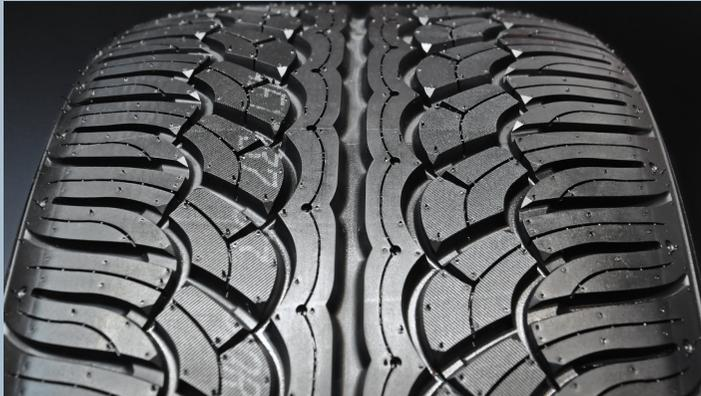
**Reifenprofil:** Mindestprofiltiefe von 1.6mm nie unterschreiten. Für Winterreifen besser 3-4mm und für Sommerreifen besser 2-3mm. Bei abgelaufenen Reifen droht vermehrte Aquaplaning Gefahr schon bei geringen Geschwindigkeiten. Ausserdem drohen Busse oder Führerausweisentzug.
